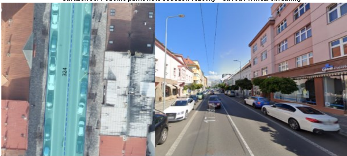
Obrázek 36: Podélné parkoviště součástí vozovky – Obvod PK mezi obrubníky
