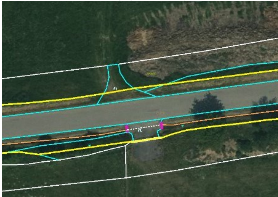
Obrázek 57: Obvod PK včetně propustku v rámci sjezdu/nájezdu v extravilánu
