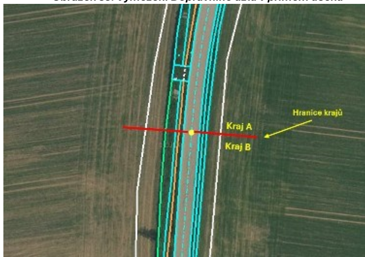
Obrázek 88: Vymezení Dopravního uzlu v přímém úseku
