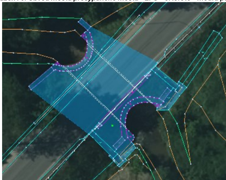
Obrázek 70: Obvod mostu přesýpaného mostu – ZPS + ortofoto – modrá plocha
