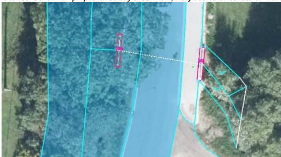
Obrázek 59: Obvod PK – propustek dělený chodníkem, který neslouží k odvodnění komunikace
